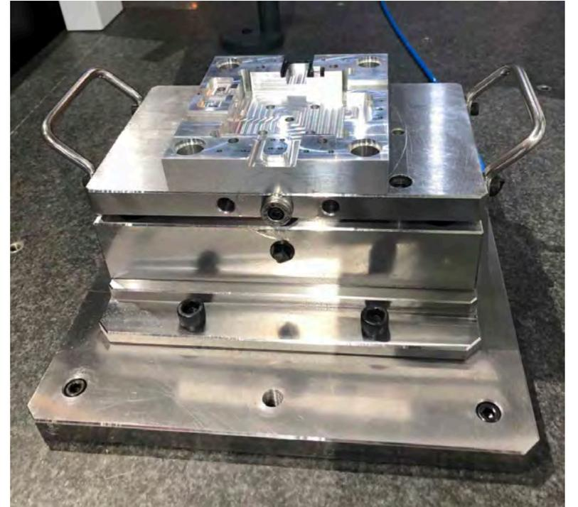
採用油壓或器壓驅動的快速夾具交換系統可以快速的交換夾具，也可以用ROBOT取放夾具底板！
