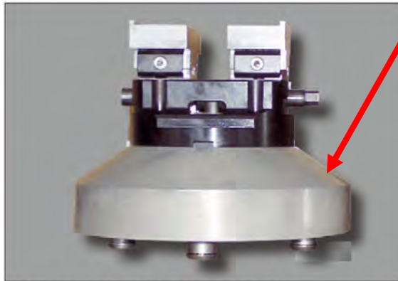
在五面加工機上，快速交換托板與虎鉗。
