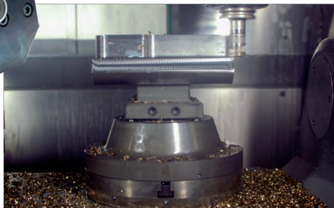
無間隙結合與板型彈簧的高預壓力，造就極高的剛性。
