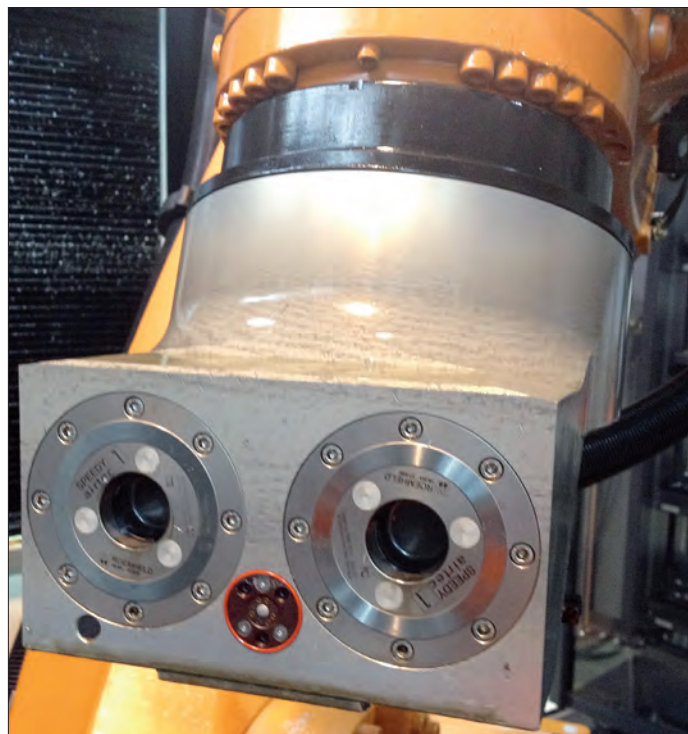
實例：機械手臂上的多通道耦合器。
