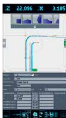
軟體功能可量測刀尖的最大輪廓。
