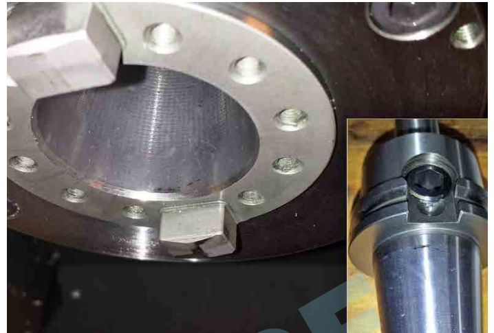
主軸振動造成的內部損壞和刀桿圓錐部位造成的磨損。
