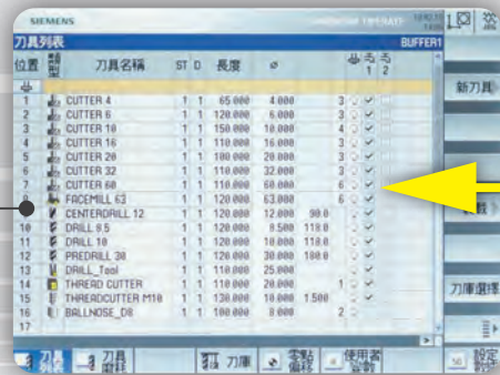
加工機控制系統中的刀庫位置編排畫面(以西門子840D為例)
