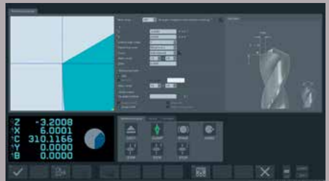
有中空研磨的鑽頂角-追蹤從起點(外徑)到刀具尖點的輪廓進行量測。
