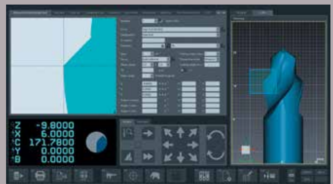
ZOLLER »caz« – 適用於外部PC工作站的虛擬量測設備，用在刀具製造前建立檢驗和量測程序，透過3D刀具模型進行量測程式、標準值、公差..等設定。
