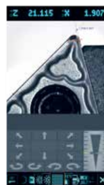
刀尖破損檢查功能（標準功能）。
