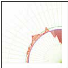
圓弧刀具專業量測軟體 - 呈現刀具實際圓弧輪廓上的各點差異。
