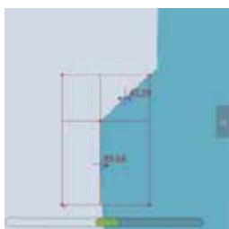
自動辨識量測刀具的輪廓轉接點
