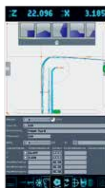
軟體功能可量測刀尖的最大輪廓。
