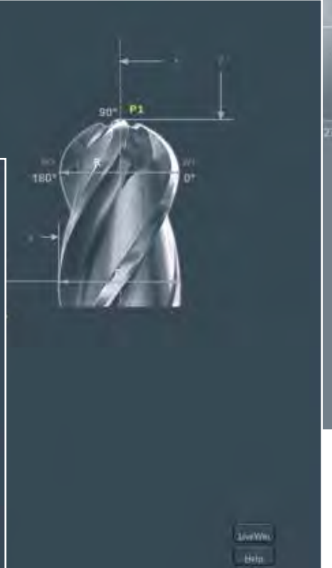
量測程式 137: 全自動量測球刀R值輪廓
