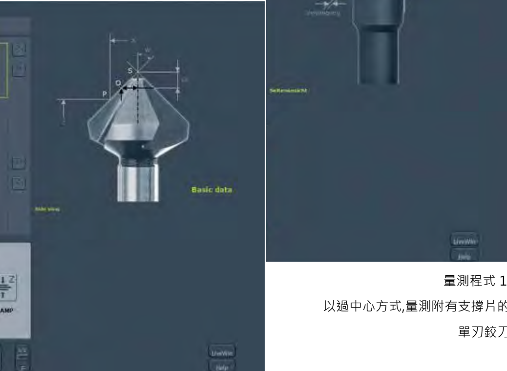
量測程式 17: 透過量測刀刃形狀來定義理論 交叉點
