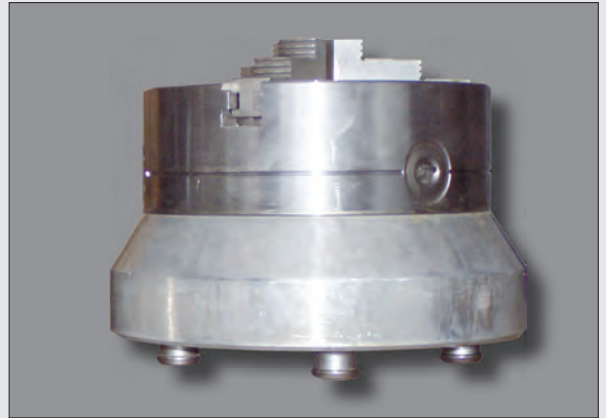
在五面加工機上，快速交換托板與三爪夾頭。
