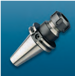
DIN 69871 SK40/50 ER 筒夾刀桿 COLLET CHUCK ER, 夾持ER16/25/32/40, 有效長70~200mm
