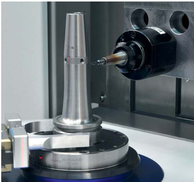
以CNC機能自動修正不平衡量 Automated compensation of unbalance via CNC machining unit
