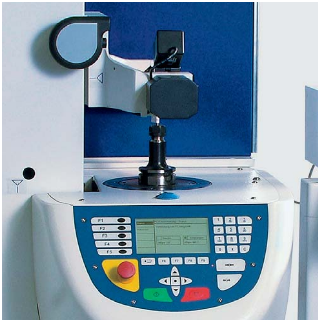
量測系統配備高解析度攝影機與數位影像量測程序
