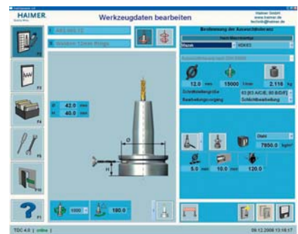
直覺的使用者導引與圖形的輔助說明 Intuitive user guidance with graphical help functions
