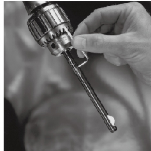
可在機器上調整與更換刀片
