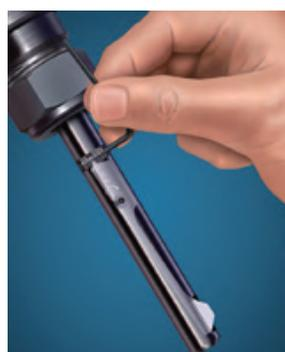
順時針旋轉調整螺絲，加大刀片張力，增加去毛邊量。
