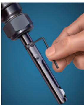
逆時針旋轉調整螺絲，降低刀片張力，減少去毛邊量。
