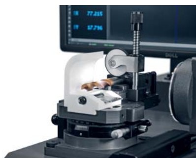
迴轉基座旋轉在 45°位置，量測刀具的倒角或圓弧。
