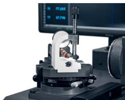
迴轉基座 (加反光板)，迴轉 90°在徑向的量測位置。
