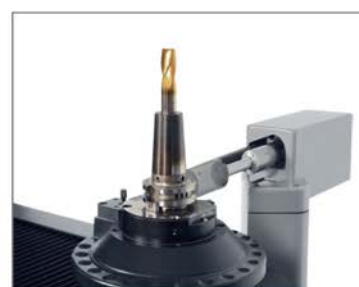
應用 RF/ID 刀具識別系統 *
