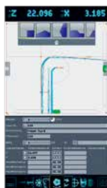
軟體功能可量測刀尖的最大輪廓。
