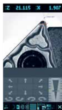
刀尖破損檢查功能（標準功能）。
