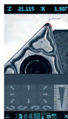
刀尖破損檢查功能（標準功能）。
