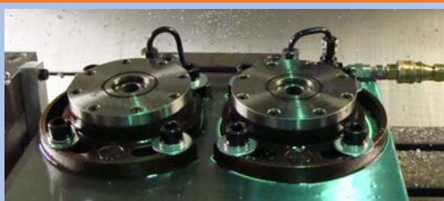
機器底板上安裝快速 夾具交換系統
