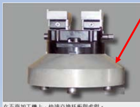
在五面加工機上, 快速交換托板與虎鉗。
