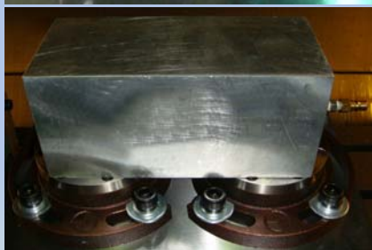
工件胚料下方裝有拉栓 ，直接安裝在夾具底板 上加工。可以做到五面 加工的工作。
